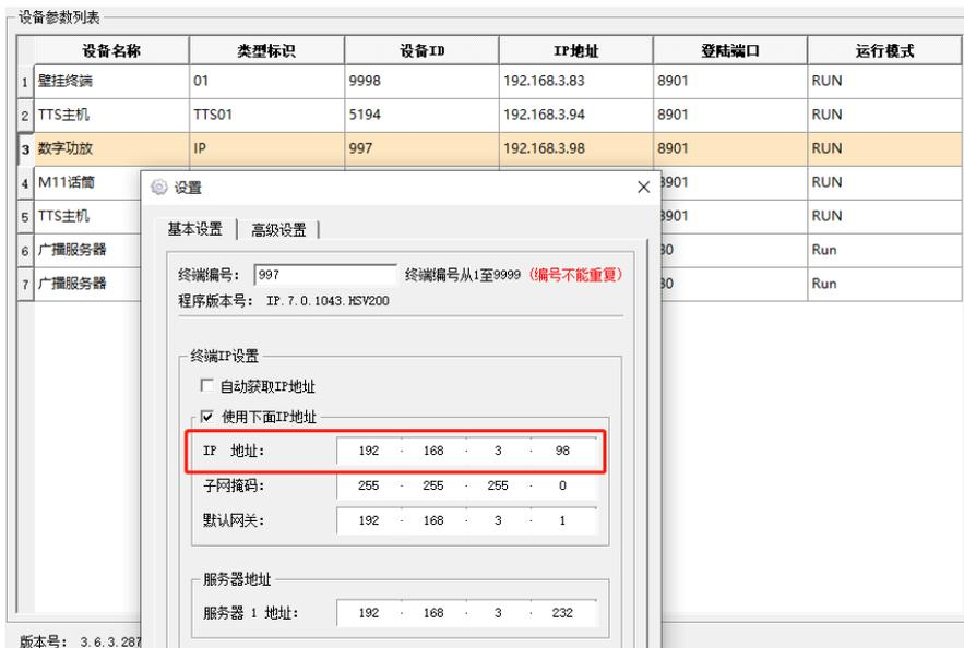
2、用非 IE 内核的浏览器在地址栏输入待测试设备的 IP 地址+888，并输入收取吗：87654321，如
